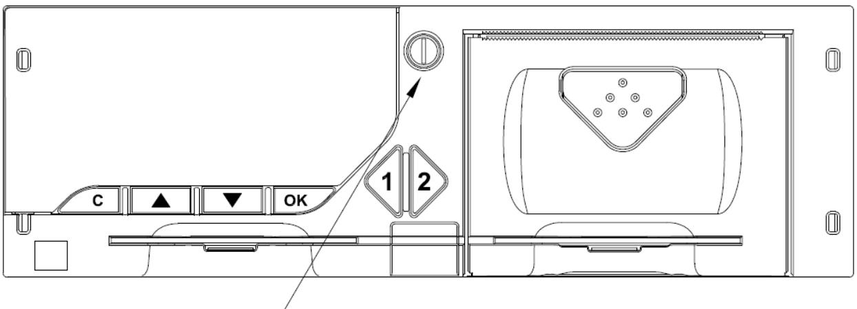
Открутить пломбировочный винт
