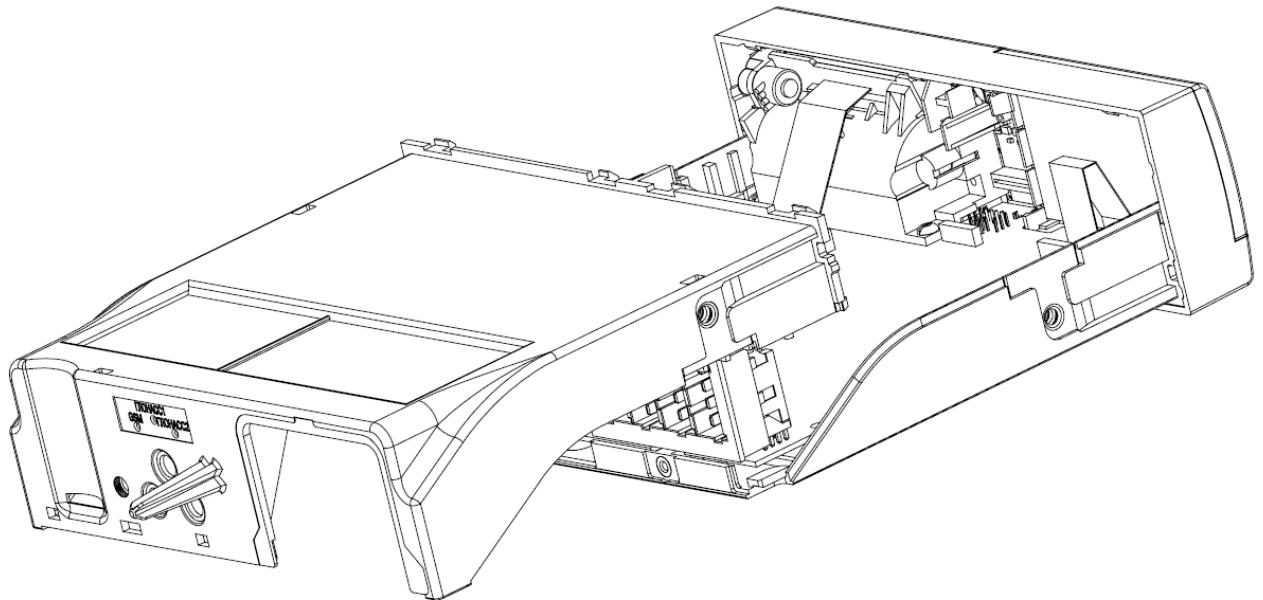
Сдвинуть и снять кожух
