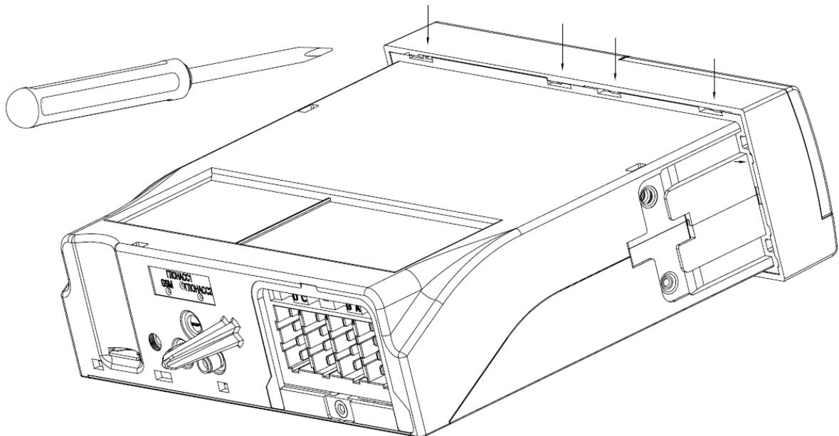
*Отжать отверткой или другим плоским предметом защелки в указанных местах*
