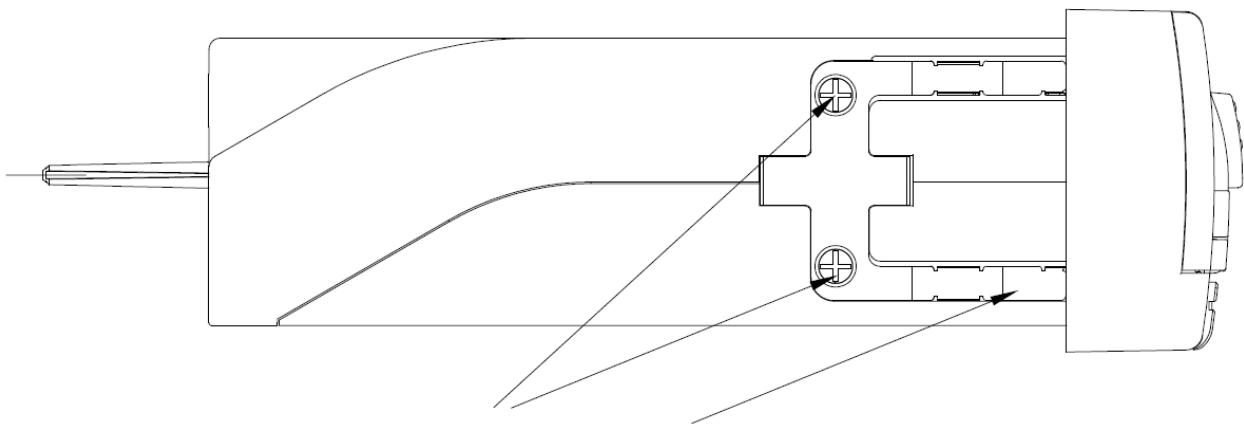
Открутить винты и снять замок
